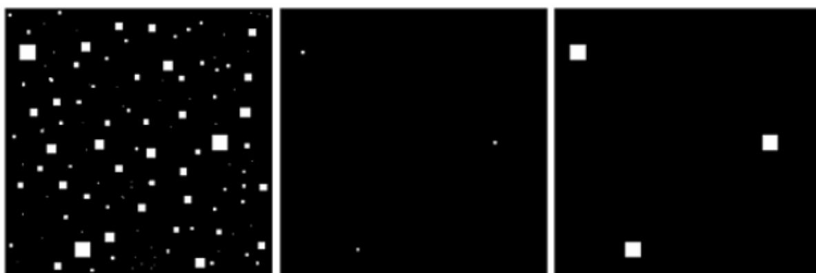
Obrázek 8 Obrázek se čtverci o velikosti 1, 3, 5, 7, 9, a 15 pixelů. Ukázka eroze a následné dilatace se stejným strukturním elementem. [7]
