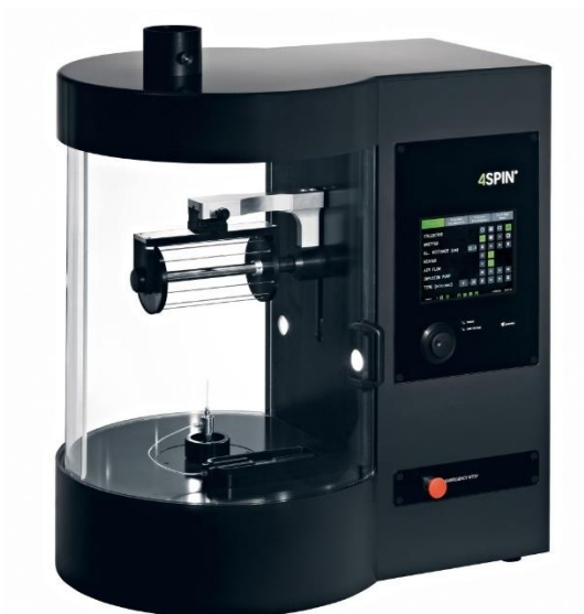
Obrázek 3 Laboratorní zařízení 4SPIN pro metodu elektrostatického zvlákňování
