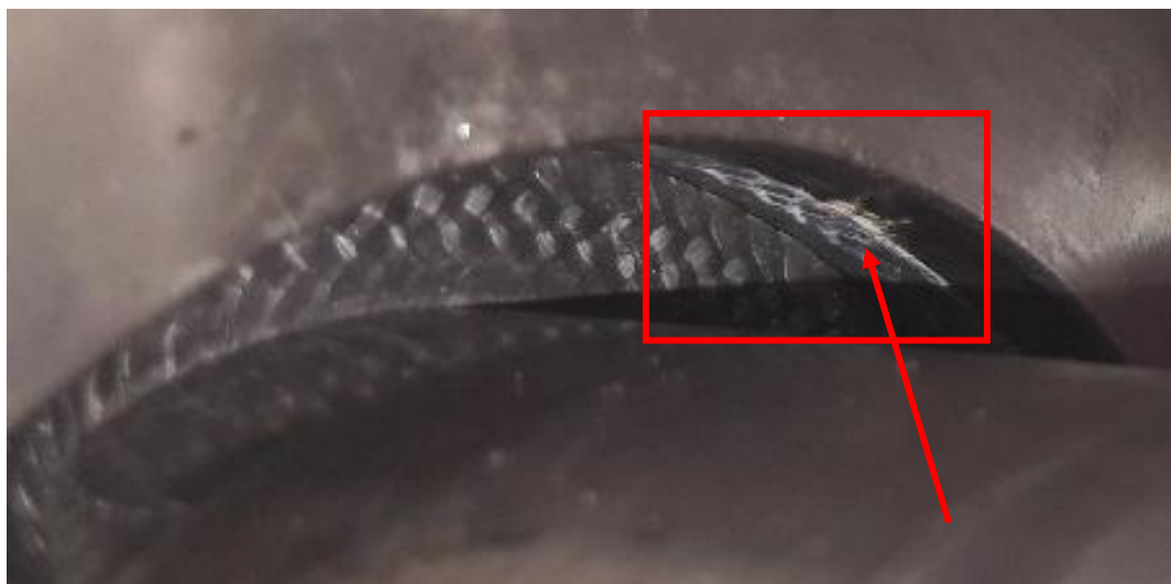
Obrázek 43: Stopy korundu pod prvním kroužkem těsnění
