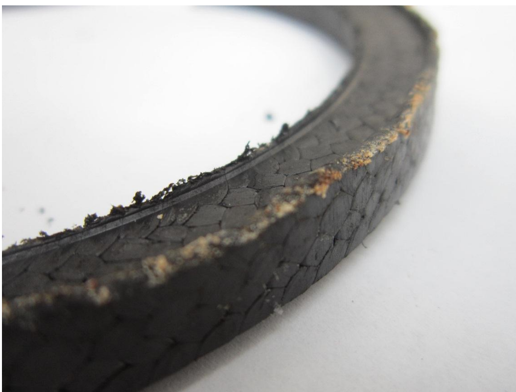
Obrázek 46: Otláčení prvního kroužku a zapečený korund
