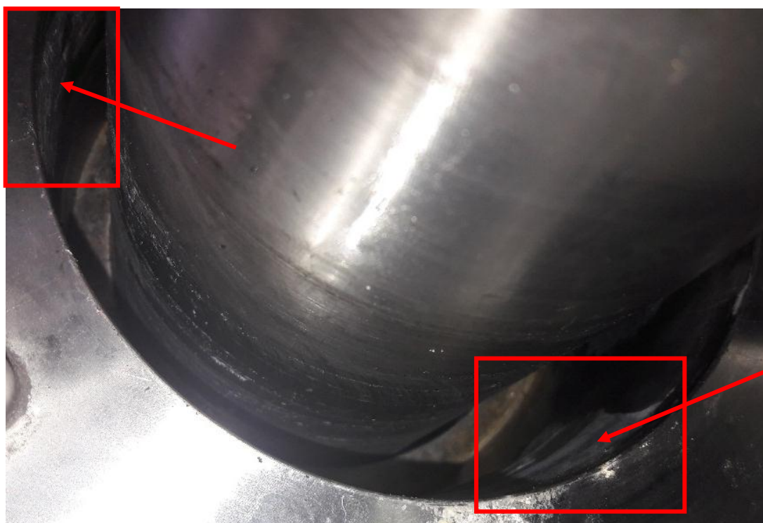
Obrázek 44: Stopy korundu v těsnicím prostoru ucpávky
