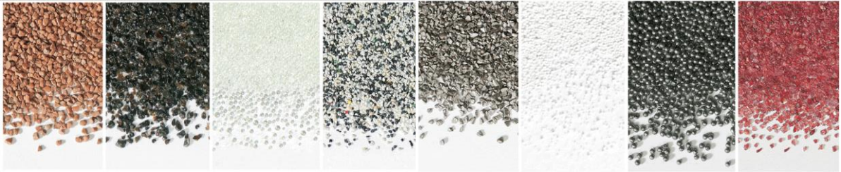
Obr. 7: Tryskací abraziva z leva: drcené pecky, hnědý korund, balotina, plastové abrazivo, ocelová drť dolomit, ocelový granulát a přírodní granát GMA. [15]
