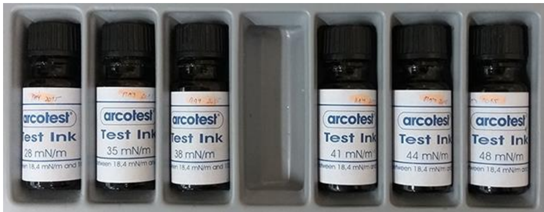
Obr. 4 Testovací inkousty pro zjištění povrchové energie pevných materiálů [5]
