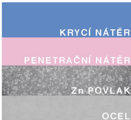
Obr. 22: Princip duplexních systémů [34]
