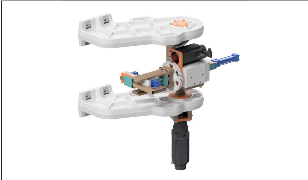
Obr. 90 – nosné rameno s pohonem osy C
