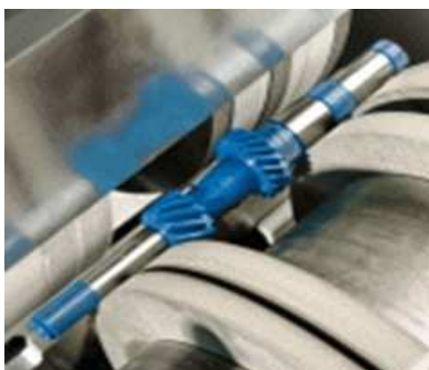
Obr. 18 Bezhraté broušení zapichovací 1,2 [13]
