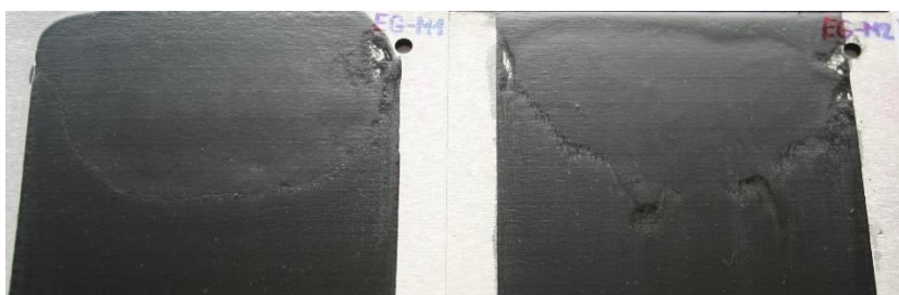
Obr. 58: Vada epoxidových nátěrů na zamaštěných vzorcích po strojním broušení (G)
