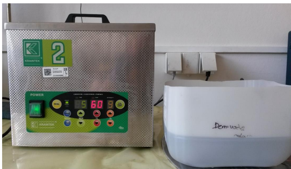
Obr. 14: Odmašťování v průmyslové ultrazvukové vaně K-2IE a oplach
