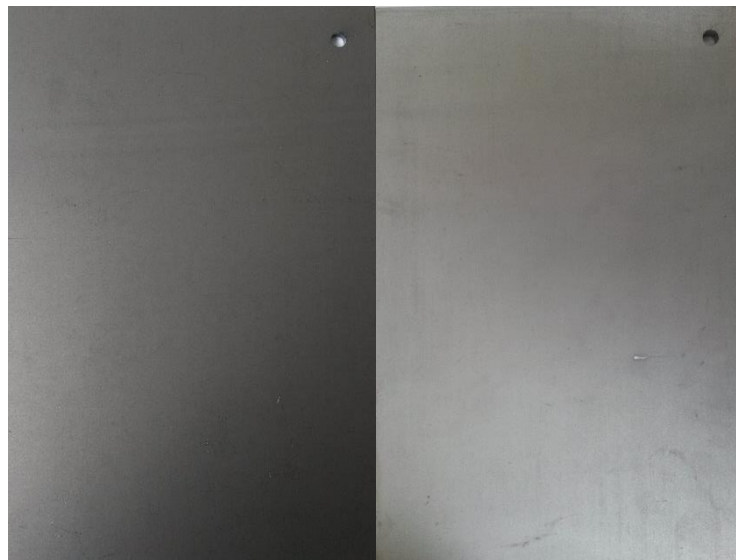
Obr. 20: Vzhled vzorku před mořením (vlevo) a po moření (vpravo)
