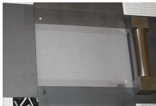
Obr. 12: Čtyřhranné nanášecí pravítko [40] Obr. 13: Aplikace NH pomocí pravítka a folie
