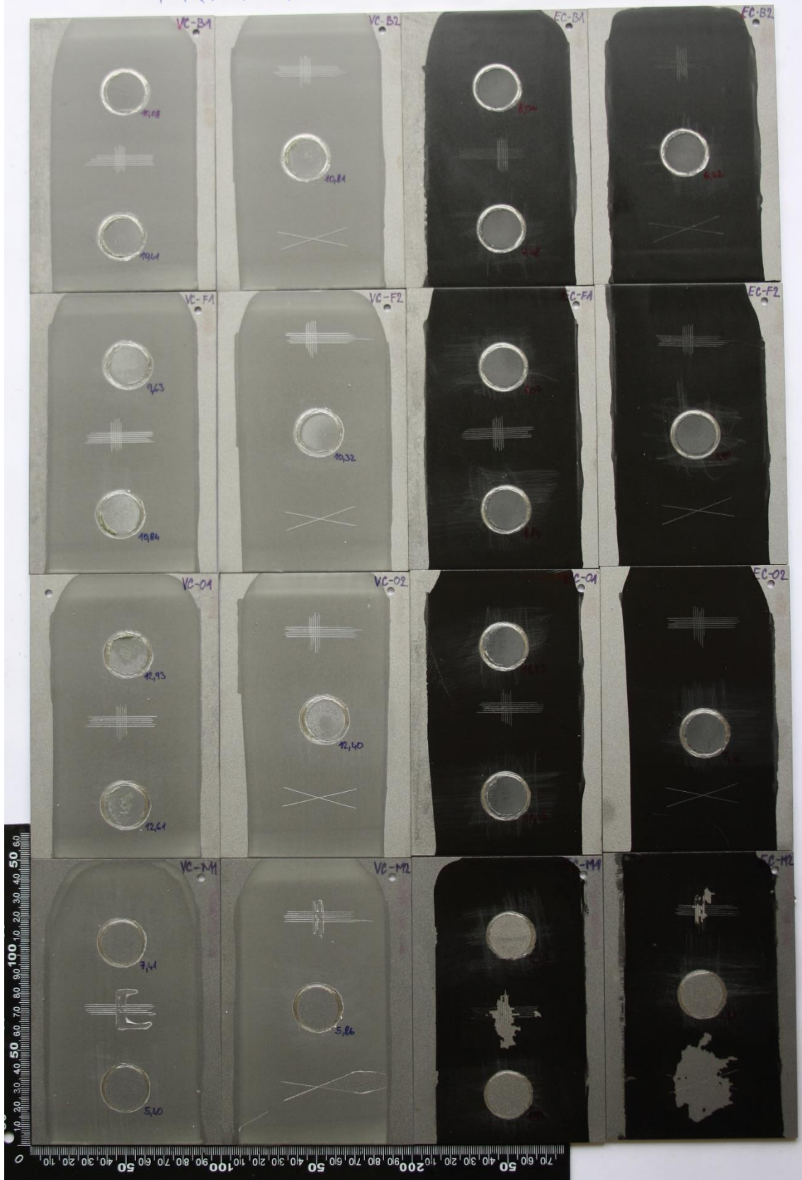
Obr. 66: Sada vzorků po tryskání křemenným pískem (C)
