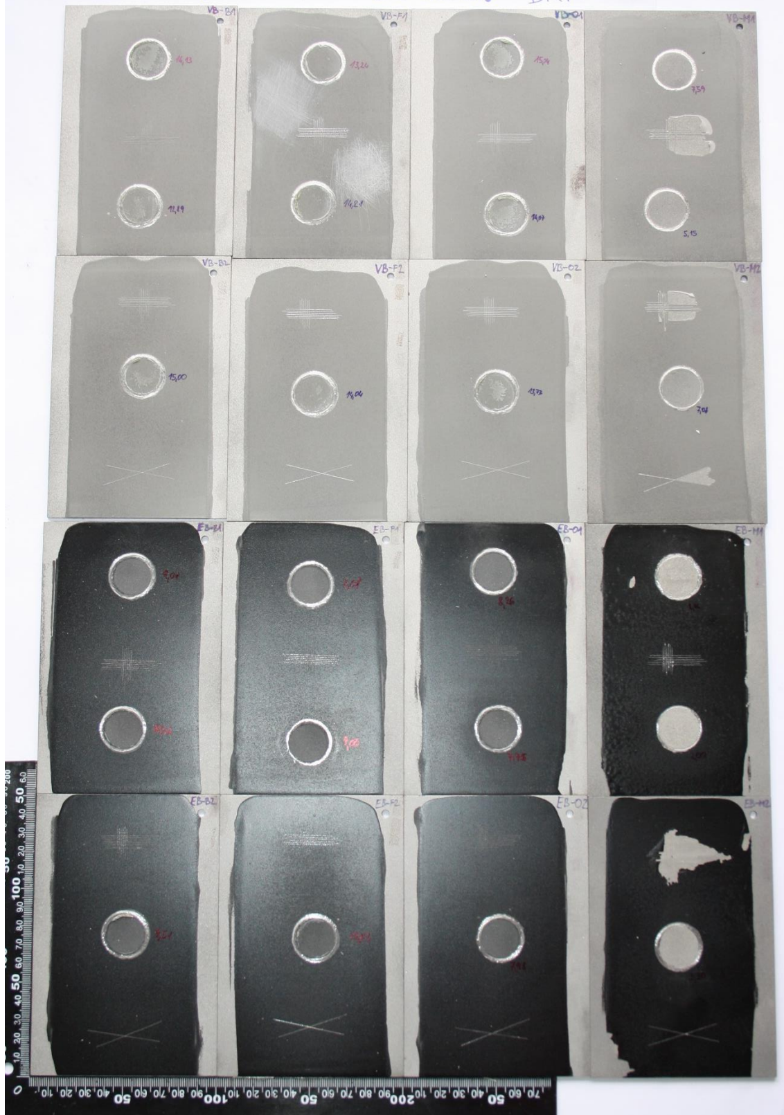
Obr. 65: Sada vzorků po tryskání ocelovou drtí (B)
