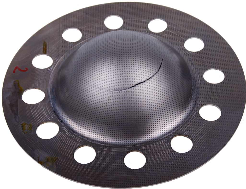
Obrázek 6.2: Zkušební vzorek po Nakazima punch testu
