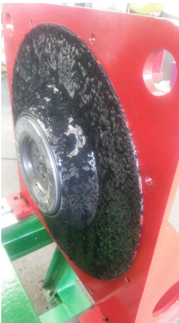
Obrázek 79: Napečené částice pryže na vnitřní stěně komory mlýna
