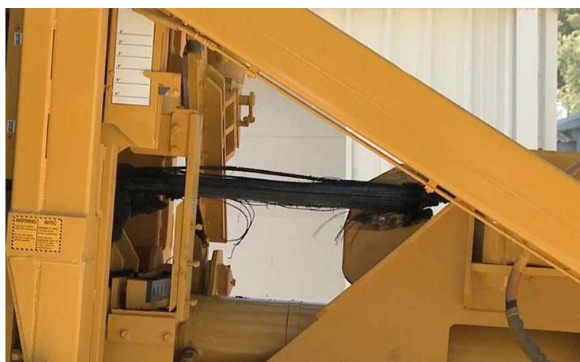
Obrázek 5: Odstraňování ocelových částí z pneumatik [7]
