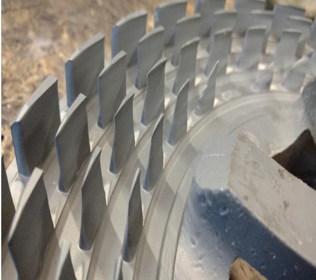
Obrázek 31: Čtyřřadé zuby s viditelným opotřebením
