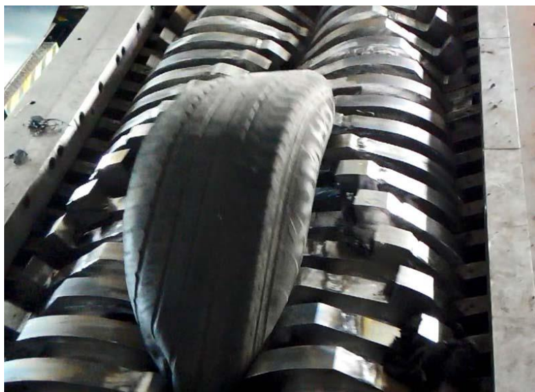
Obrázek 7: Válcový drtič s upravenými válci pro drcení pneumatik [12]
