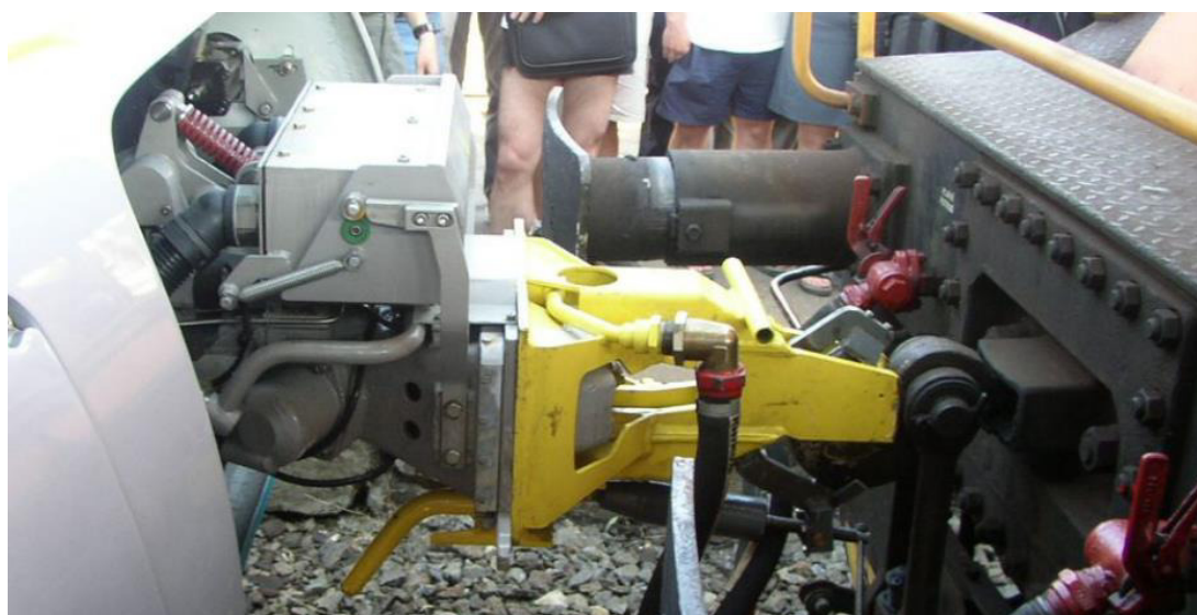
Obr. 45: Použití nouzového spřáhla v praxi (30)
