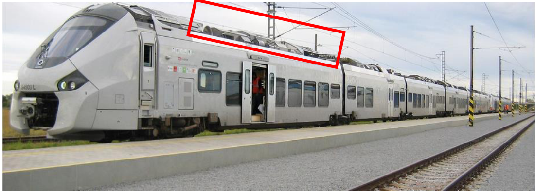
Obr. 29: Vozidlo Alstom Coradia Régiolos s diesel-elektrickým agregátem na střeše (24)
