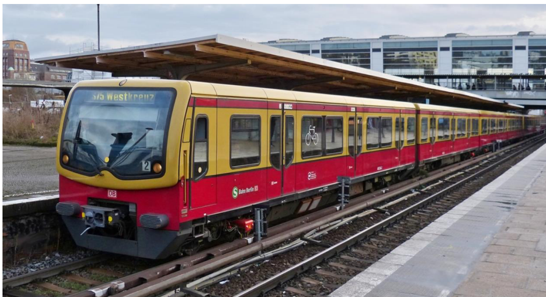
Obr. 11: Vozidlo S-Bahn dráhy napájené spodní přírodní kolejí (9)
