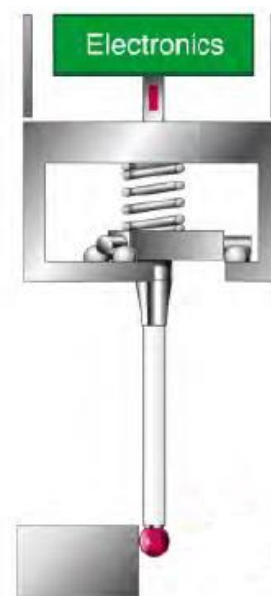
Obr. 2. 6 Schéma tenzometrického snímacího systému [15]
