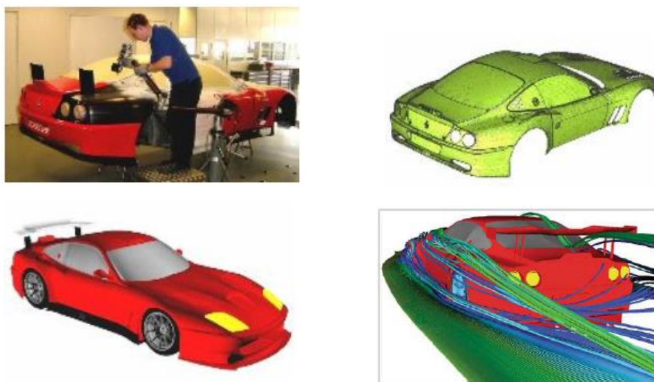
Obr. 1. 8 Využití v RE pro simulaci v aerodynamickém tunelu [10]
