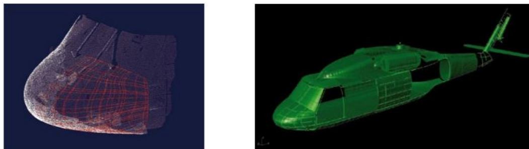
Obr. 1. 12 Vlevo: získaná data z optického skenování; vpravo: vytvořený CAD model z naskenovaných dat [12]
