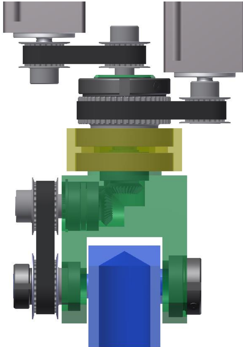
Obrázek 3-9 Konceptní 3D model hlavy
