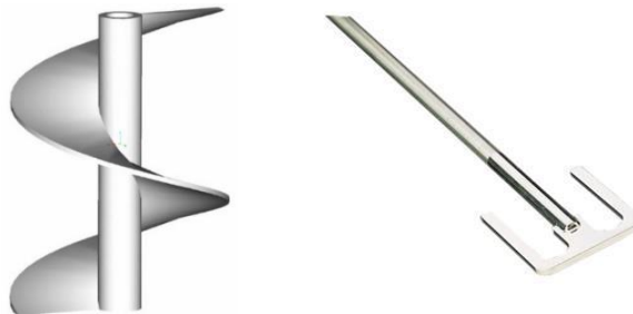
Obr. 3: Pomaloběžné míchadlo šroubové (vlevo) a kotvové (vpravo) [20] [21]
