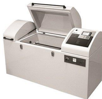
Obr. 45: Korozní komora Liebisch S 400 M-TR [42]
