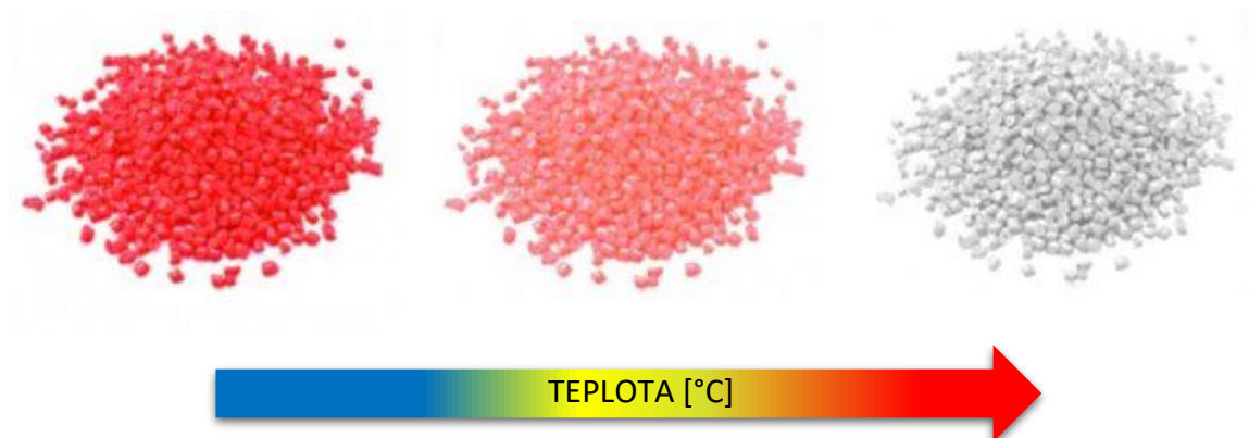
Obr. 7: Chování termocitlivého pigmentu při zvyšování teploty. Vlevo pokojová teplota, vpravo zvýšená teplota nad teplotu přechodu chemické sloučeniny. [43]
