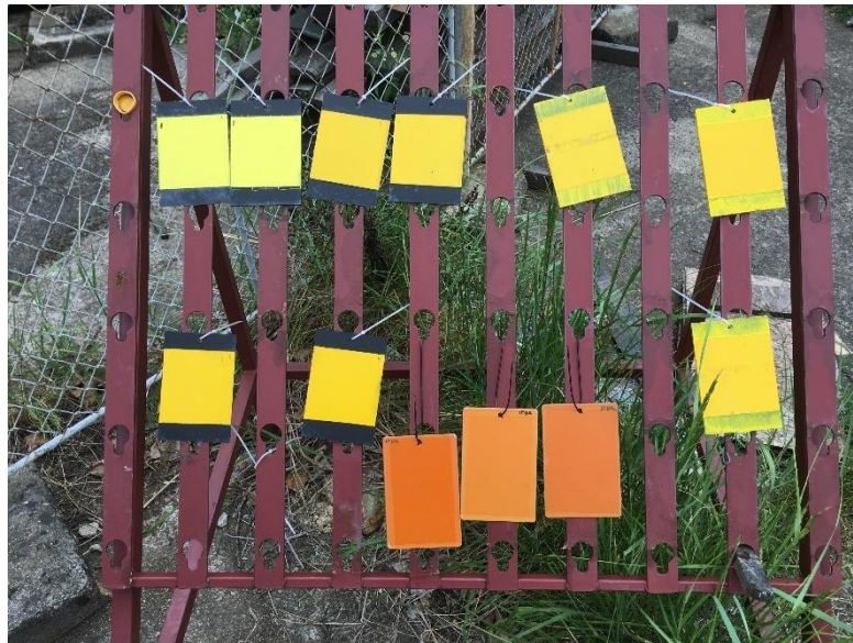
Obr. 43: Nahoře: systémy 1. série po půlročním testování s patrnou degradací odstínu termocitlivého pigmentu odkrytím žlutého pigmentovaného základního nátěru. Dole jsou umístěny systémy 2. série před testováním.
