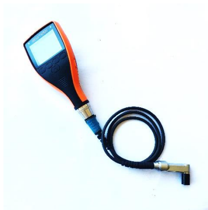
Obr. 29: Neinvazivní tloušťkoměr Elcometer 456.
