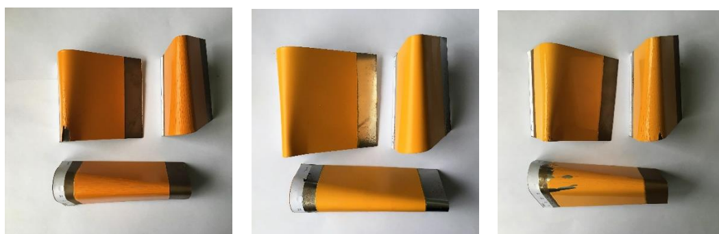
Obr. 36: Zkouška ohybem 1. série na kónickém trnu – zleva: IP04, IP03, IP02
