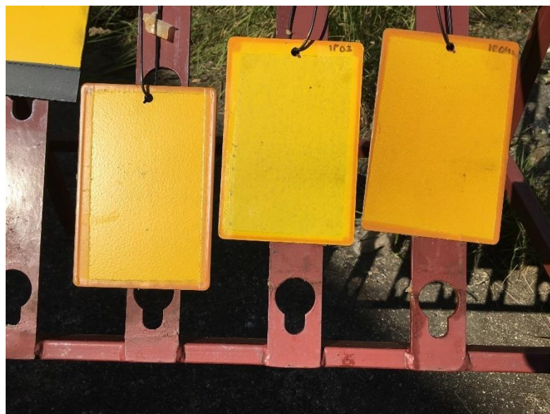
Obr. 43: Nahoře: systémy 1. série po půlročním testování s patrnou degradací odstínu termocitlivého pigmentu odkrytím žlutého pigmentovaného základního nátěru. Dole jsou umístěny systémy 2. série před testováním.
