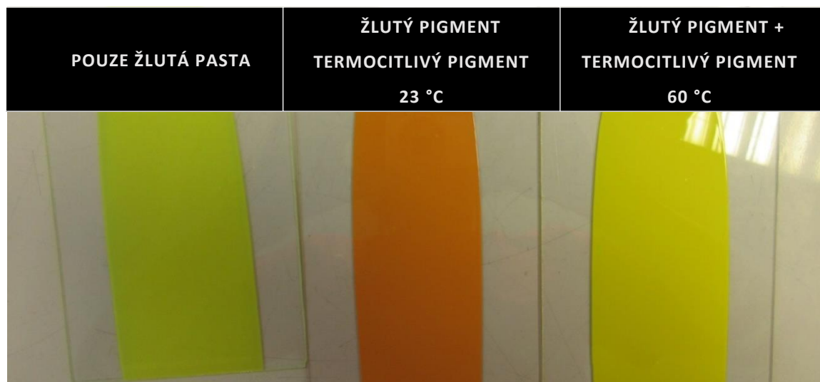
Obr. 16: Prvotní formulace nátěrové hmoty, pigmentováno 10 % žlutého pigmentu, systém IP02.
