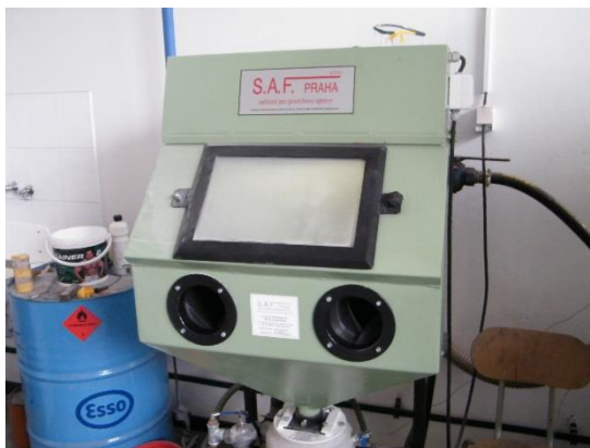
Obr. 23: Tryskací zařízení S.A.F. Praha a ukázka otryskaného vzorku z konstrukční oceli S235.
