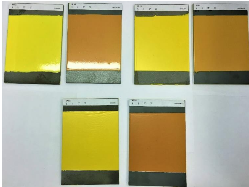
Obr. 27: Výsledné systémy 1.série před testováním. Zleva nahoře: IP02; IP03 a IP04. Vlevo je vzorek vždy ohřátý na teplotu přechodu barevné změny.
