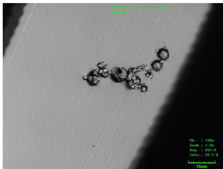
Obr. 14: Mikroskopický snímek pigmentu, na kterém je vidět rozmanitost velikostí jednotlivých částic.
