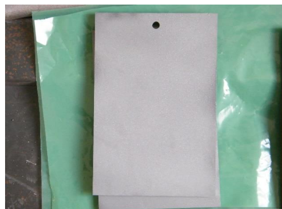
Obr. 23: Tryskací zařízení S.A.F. Praha a ukázka otryskaného vzorku z konstrukční oceli S235.
