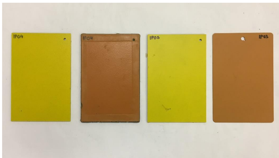
Obr. 28: Výsledné systémy 2. série před testováním. Zleva IP04 a IP03. Vlevo je vzorek vždy ohřátý na teplotu přechodu barevné změny.
