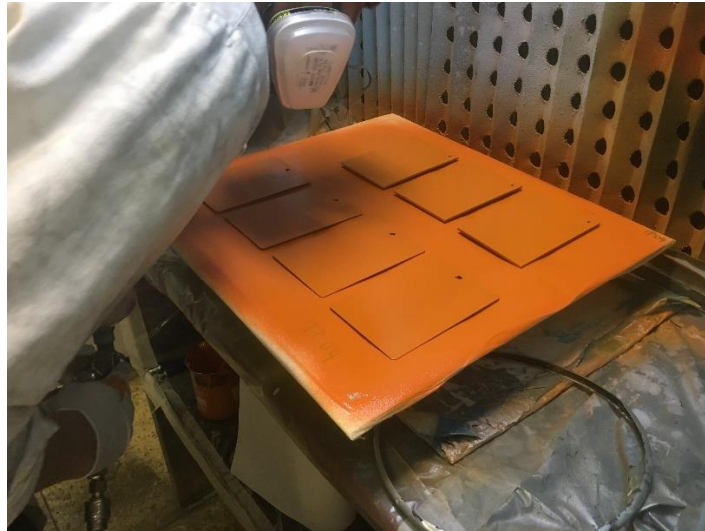
Obr. 26: Proces aplikace nátěrové hmoty IP04 pneumatickým stříkáním.
