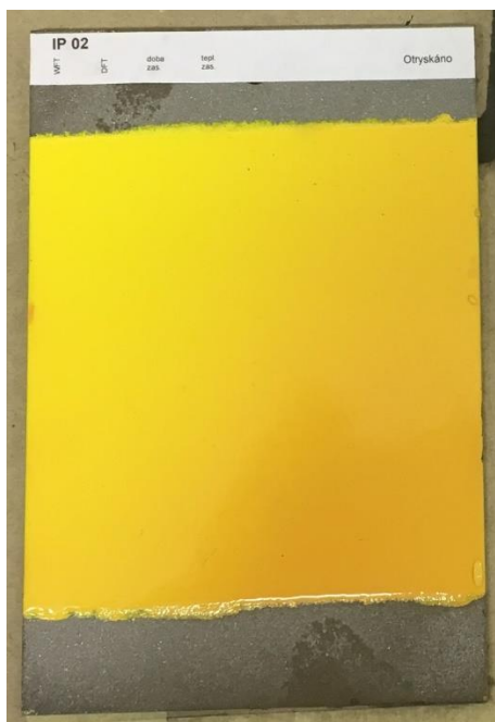
Obr. 30: Vzorek systému IP02 1.série po 18. cyklu zatížení při pokojové teplotě. V pravém dolním rohu jsou viditelné zbytky nedegradovaného pigmentu.
