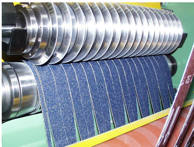
Obr. 23.: Wrap slitting, nože ve svěrných držácích [19]
