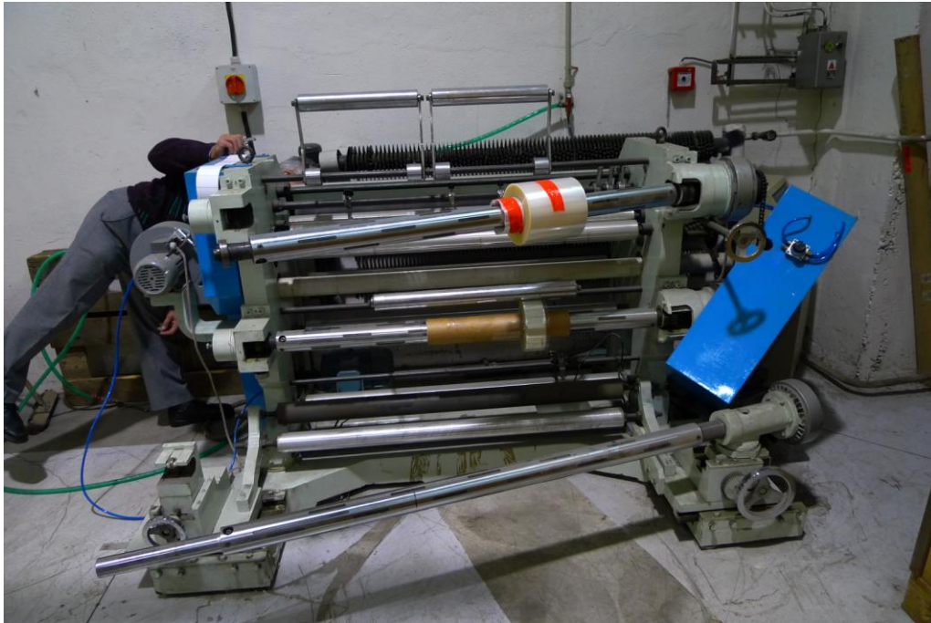
Obr. 43.: Vyklopení odvíjecí a navíjecí hřídele
