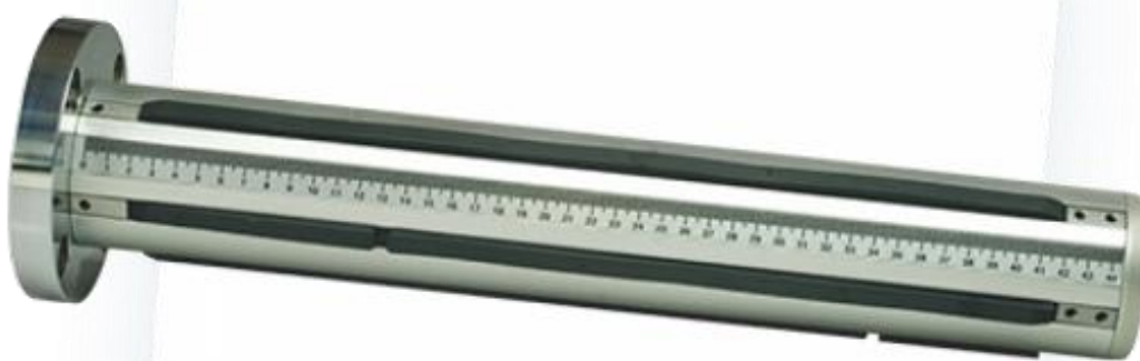
Obr. 32.: Hřídel s upínacími pásy [23]
