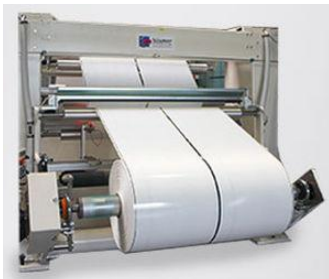
Obr. 26.: Řezačka s jedním navíjecím hřídelem [21]
