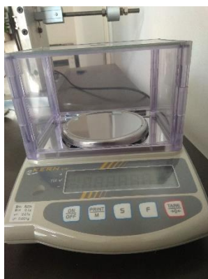
Obr.73 Laboratorní váha KERN EW 620-3NM.
