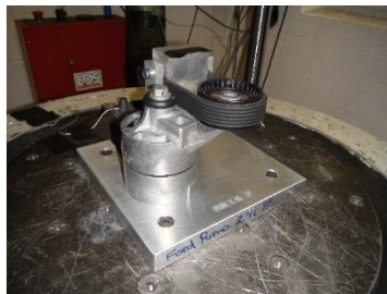
Obr.45 Upevnění napínačku řemene při testu rezonance [35].
