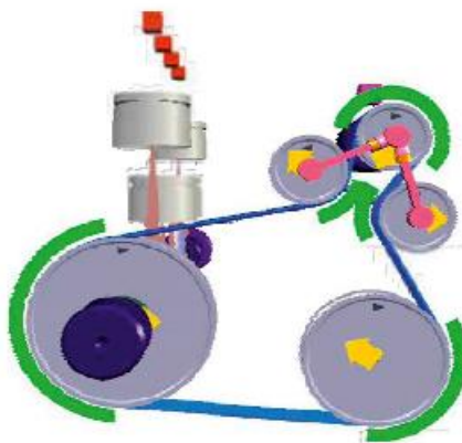
Obr.20 Schéma zapojení napínáku DAT [14].
