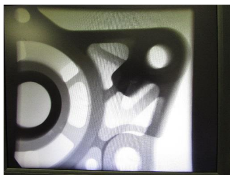
Obr.29 Rentgenový snímek skříně napínačku řemene.
