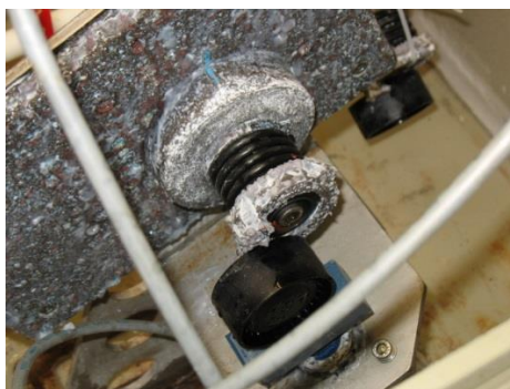
Obr.41 Napínák řemene v solné mlze.
