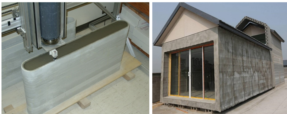
Obrázek 4 – Vytisknutá zeď technologií Contour Crafting vlevo, vytisknutá budova vpravo [f]
