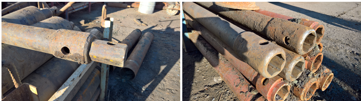
Obr. 54: Vrtací tyče - spojení pomocí vnějšího a vnitřního šestihranu
