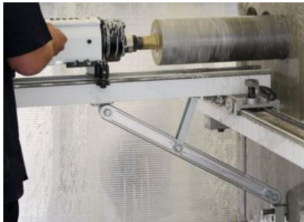
Obr. 41: Jádrové vrtání do betonu s použitím vodního výplachu [13]
