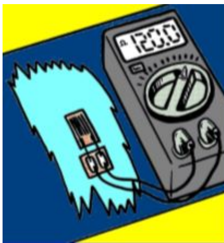
Obr. 34: Kontrola elektrické funkčnosti [19]
