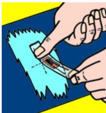
Obr. 31: Přilepení lepicí páskou [19]
