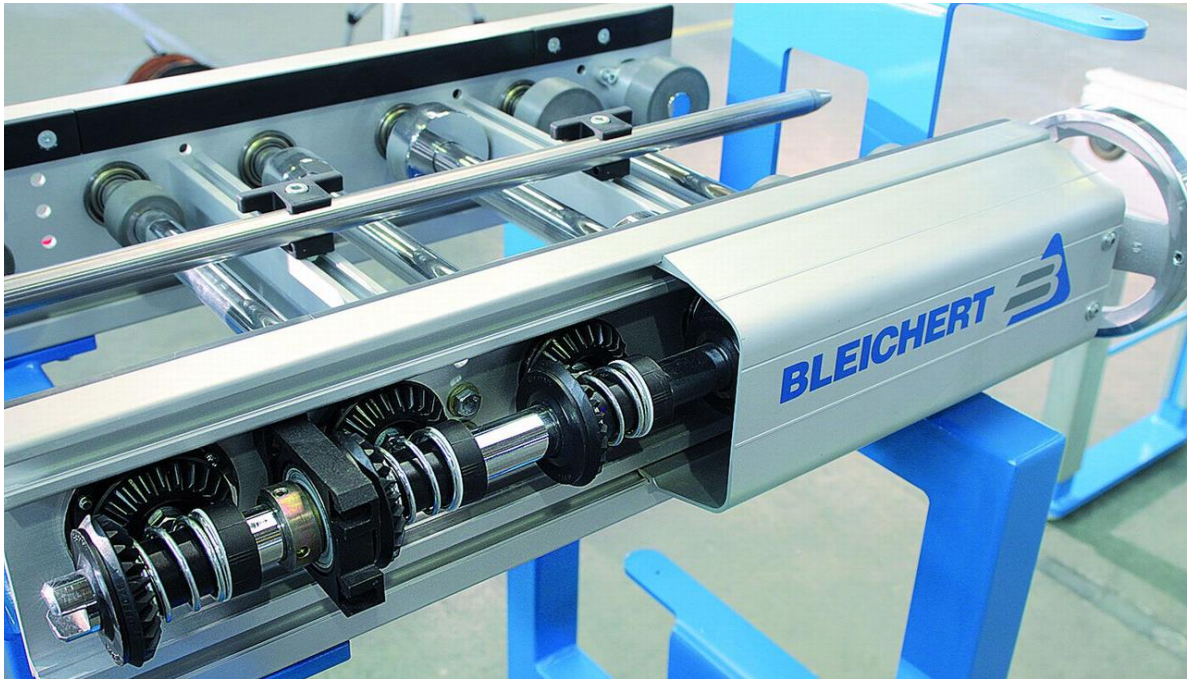
Obrázek 4 Pohon kuželovým soukolím válečkového dopravníku [3]
