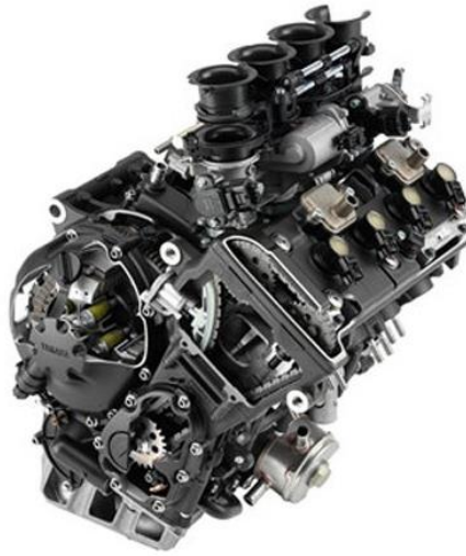
Obr. 9 - Motor Yamaha YZF-R6 v čiastočnom reze [12]
