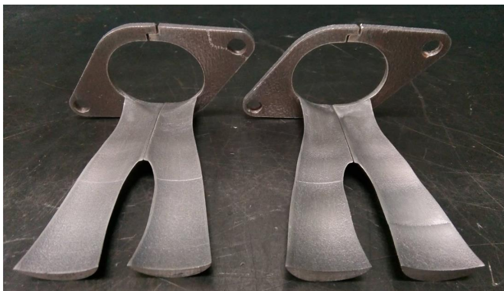
Obr. 28 – Variant v1 (vľavo) a v2 (vpravo) hliníkových vložiek vyrobené sintrovaním
