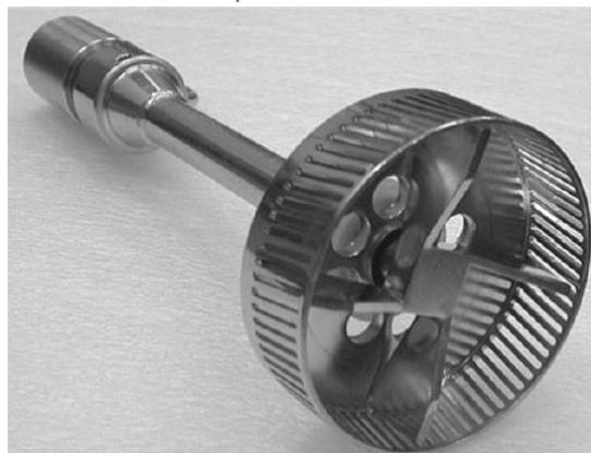
Obr. 17. Schematický náčrt experimentálního aparátu pro tenzometrické měření příkonu a dispergačního míchadlo firmy VMI [13]
