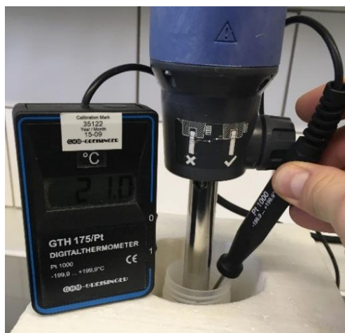
Obr. 56. Měření teploty kapaliny kalibrovaným termometrem
