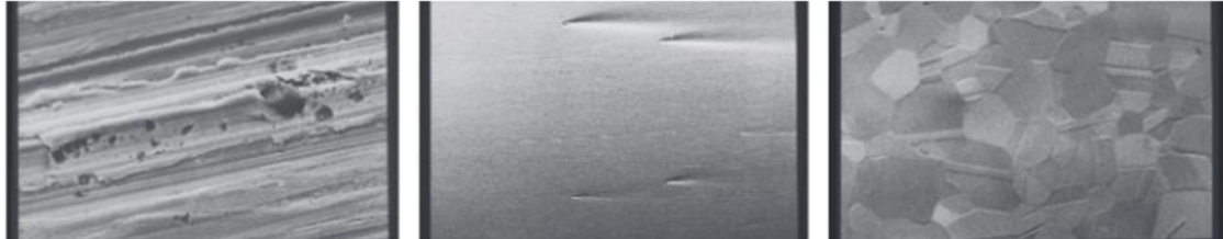
Obr. 3 Povrch korozivzdorné oceli po úpravě povrchu broušený (vlevo), mechanicky leštěný (uprostřed), elektrolyticky leštěný (vpravo) [12]
