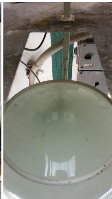
Obrázek 10. Dno nádoby ve stavu vznosu se skleněnou balotinou
