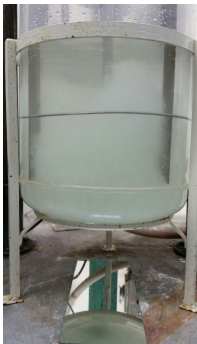
Obrázek 9. Nádoba ve stavu vznosu se skleněnou balotinou
