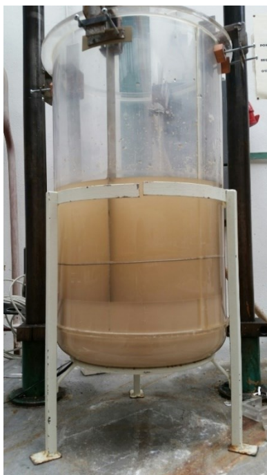
Obrázek 11. Nemíchaná nádoba se sádrovcem
