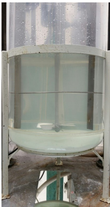
Obrázek 8. Nemíchaná nádoba se skleněnou balotinou
