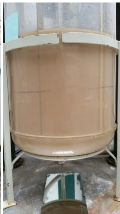
Obrázek 12. Nádoba ve stavu vznosu se sádrovcem
