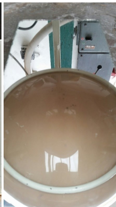
Obrázek 13. Dno nádoby ve stavu vznosu se sádrovcem
