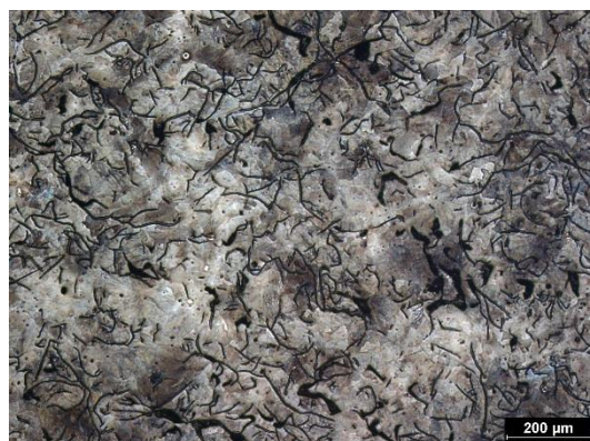
Obr. 60 Vzorek 5-1 leptaná struktura jádra, Nital 5%
