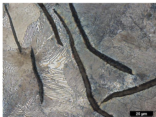
Obr. 32 Vzorek 2-2 detail leptané struktury jádra, Nital 5%
