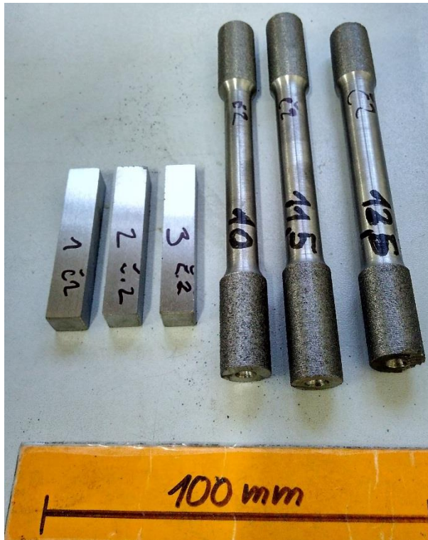
Obr. 43 Vzorky pro zkoušku lomové houževnatosti a tahovou zkoušku
