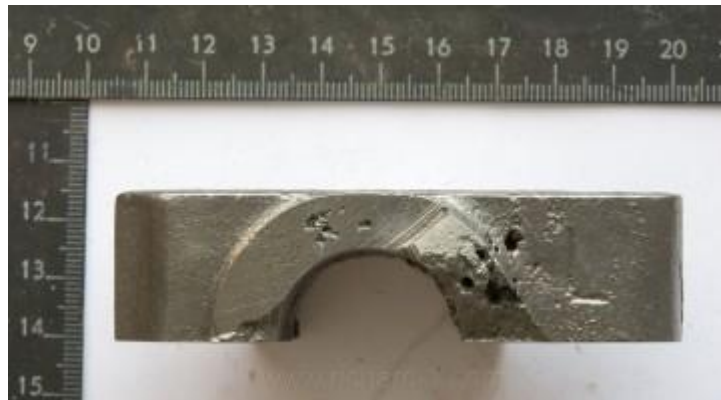
Obr. 6 Ukázka zjevné vady odlitku [10]
