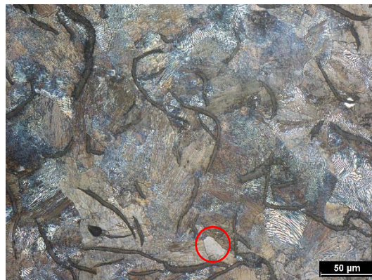
Obr. 42 Vzorek 5-2, leptaná struktura jádra, Nital 5%
