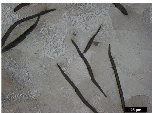
Obr. 31 Vzorek 2-1 detail leptané struktury jádra, Nital 5%
