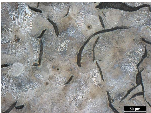
Obr. 35 Vzorek 5-1 detail leptané struktury jádra, Nital 5%
