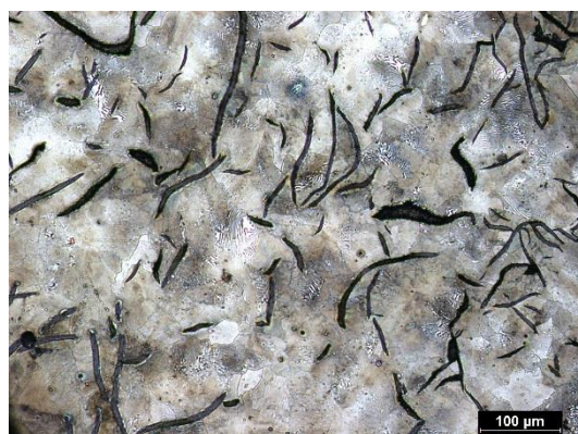
Obr. 62 Vzorek 5-1 leptaná struktura jádra, Nital 5%
