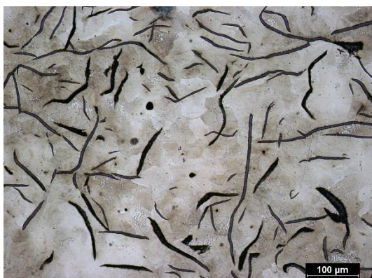
Obr. 59 Vzorek 2-1 leptaná struktura jádra, Nital 5%
