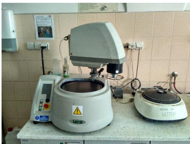
Obr. 15 Leštička LECO GPX300 (vlevo) a bruska MTH KOMPAKT 1031 (vpravo)
