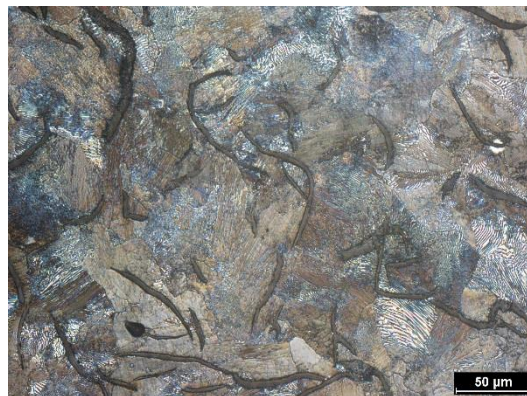
Obr. 36 Vzorek 5-2 detail leptané struktury jádra, Nital 5%
