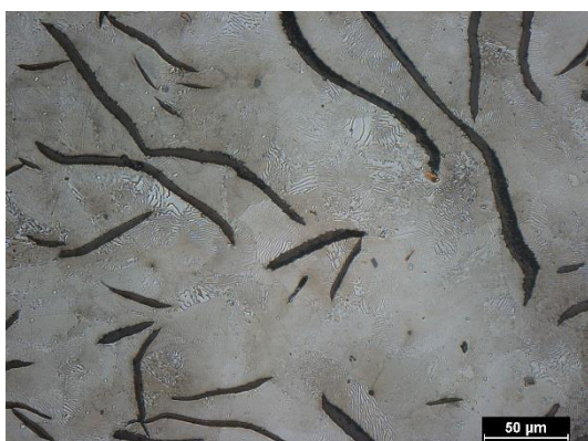
Obr. 61 Vzorek 2-1 leptaná struktura jádra v detailu, Nital 5%
