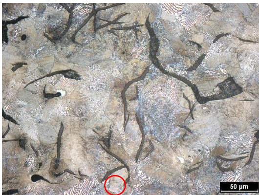
Obr. 41 Vzorek 5-1, leptaná struktura jádra, Nital 5%
