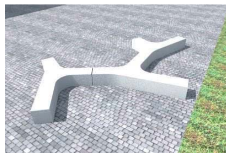
M1_BETONOVÁ LAVIČKA materiál: beton, stěrka barva: bílá
