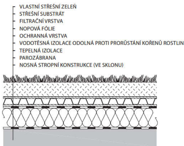
Obrázek 24 - Příklad střešního souvrství zelené střechy (26)
