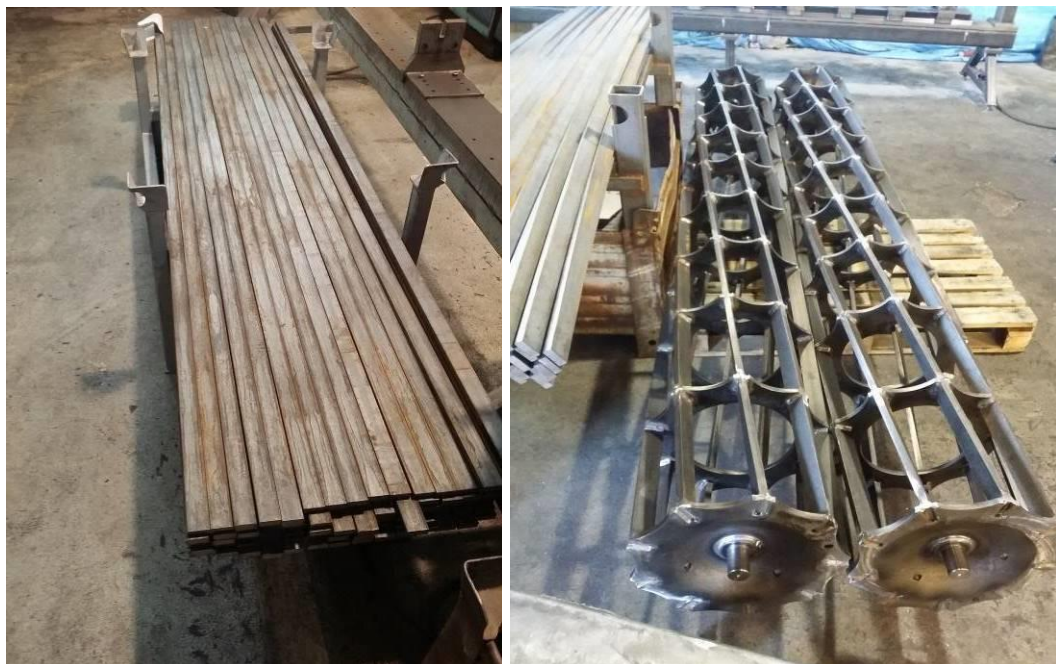
Obrázek 6: vlevo součást- pruty, vpravo finální produkt před povrchovou úpravou
