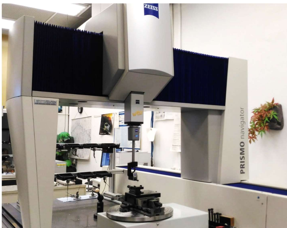
Obr. 4.11: ZEISS PRISMO navigator s hlavicí VAST a upnutým zařízením Rotos
