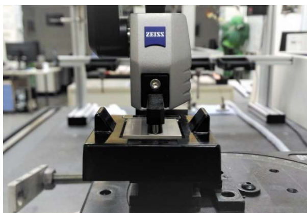
Obr. 4.16: Detail ve směru snímání zařízením Rotos
