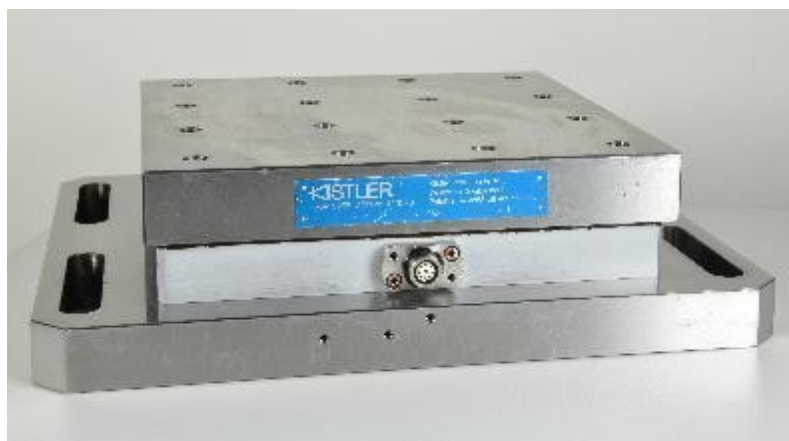
Obr. 8: Třísložkový dynamometr od firmy Kistler [20]
