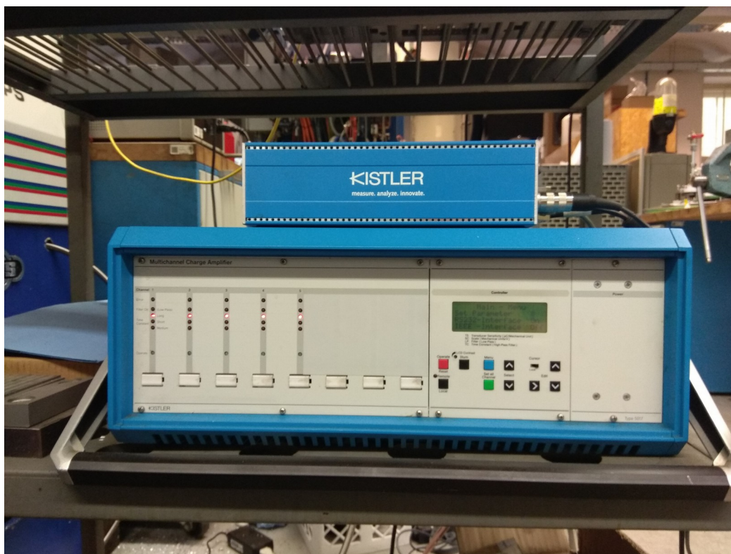
Obr. 17: Vyhodnocovací aparatura k dynamometru Kistler
