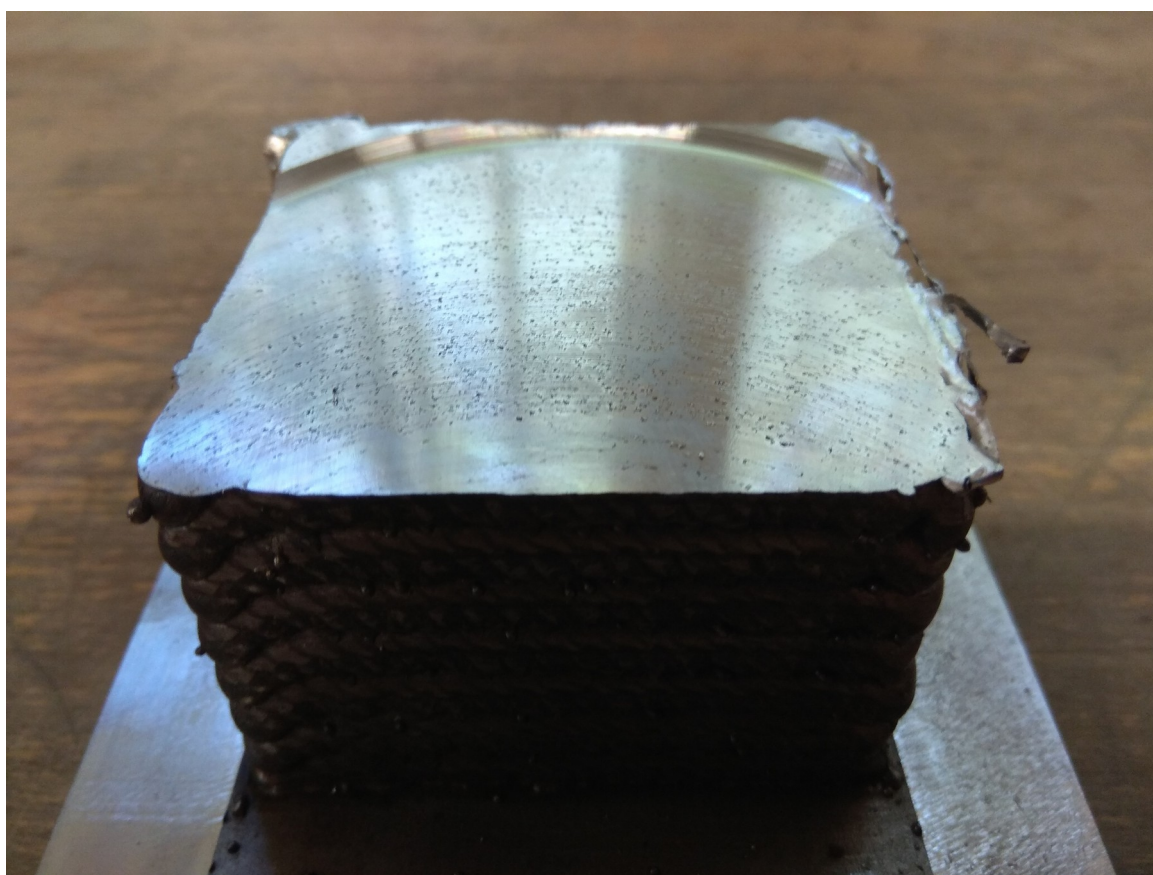
Obr. 19: Povrch poškozený při obrábění za sucha, nevhodný pro měření drsnosti
