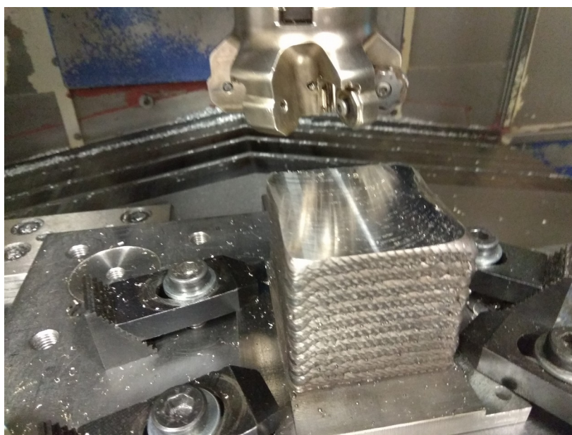
Obr. 15: Použitá fréza SECO R220.48 upnutá v obráběcím centru
