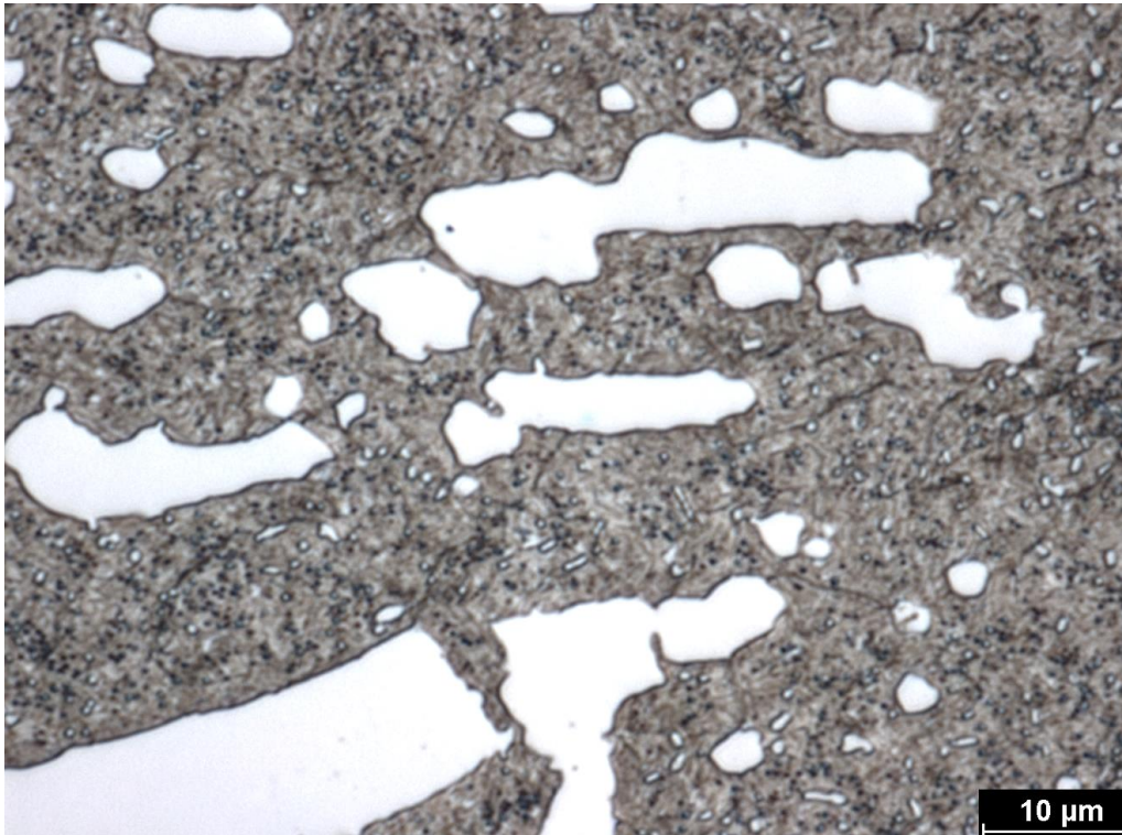
a) Kalící teplota 960 °C, teplota popouštění 180 °C
