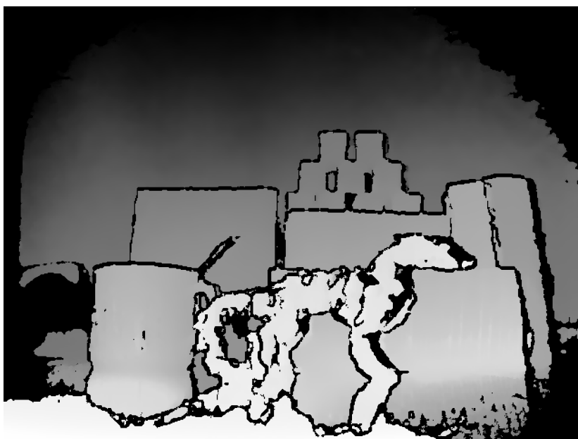
(b) Výstup pomocí kombinace Sobelovy detekce hrany a Zhang-Suen algoritmu pro ztenčení hrany
