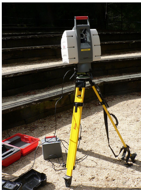
Obr. 2: Fotografie Lidar systému pro skenování 3D modelů památek, skalních formací, aj., model Leica HDS-3000 [4]. Systém má zrcátko, které rozmítá paprsek vertikálně a hlava systému se otáčí okolo horizontální osy. Systém potřebuje k řízení notebook se programem a s jeho pomocí tento systém automaticky skenuje okolí a skládá 3D modely.
