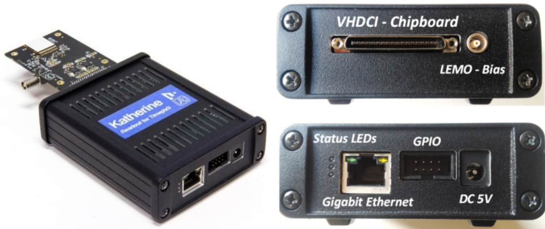
Obrázek 2.9: Vyčítací rozhraní Katherine s připojeným detektorem Timepix3 vlevo a popisem vstupních a výstupních portů vpravo[5].
