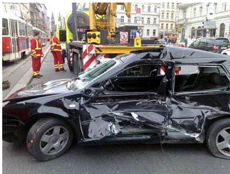
Obr. 9-47: Průnik spřáhla do interiéru osobního automobilu
