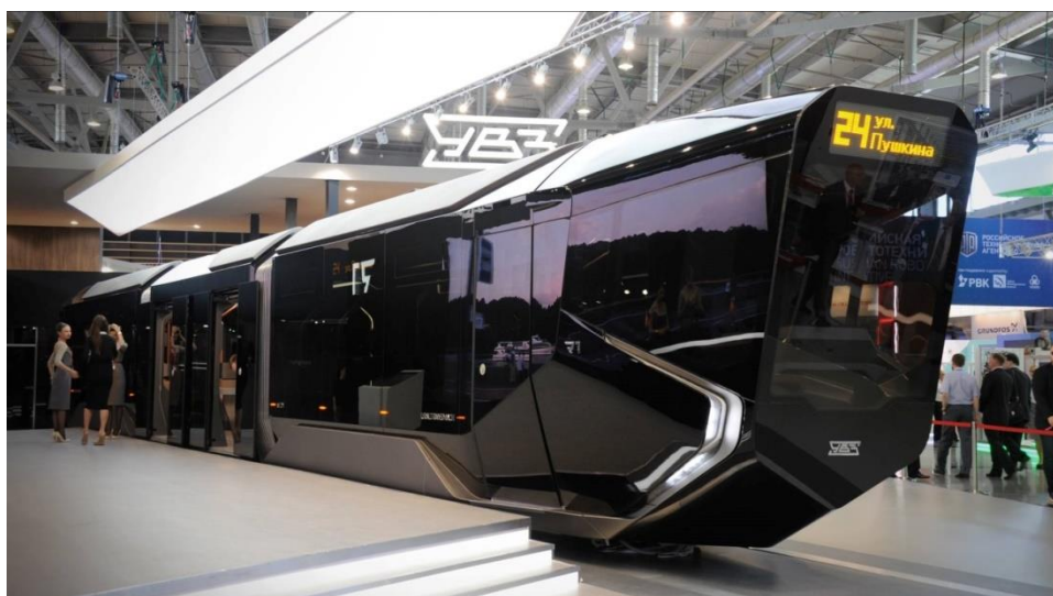
Obr. 2-6: Nevhodný tvar čela tramvaje
