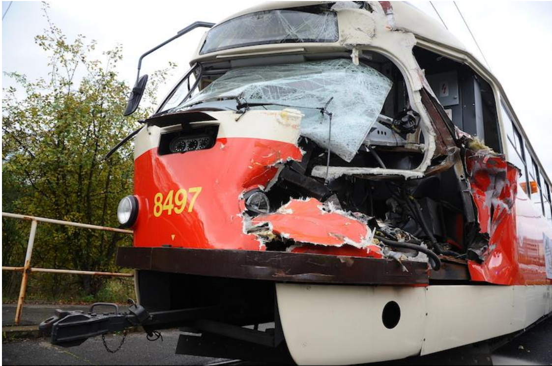
Obr. 4-6: Porušení předního sloupku kabiny tramvaje při srážce s nákladním automobilem
