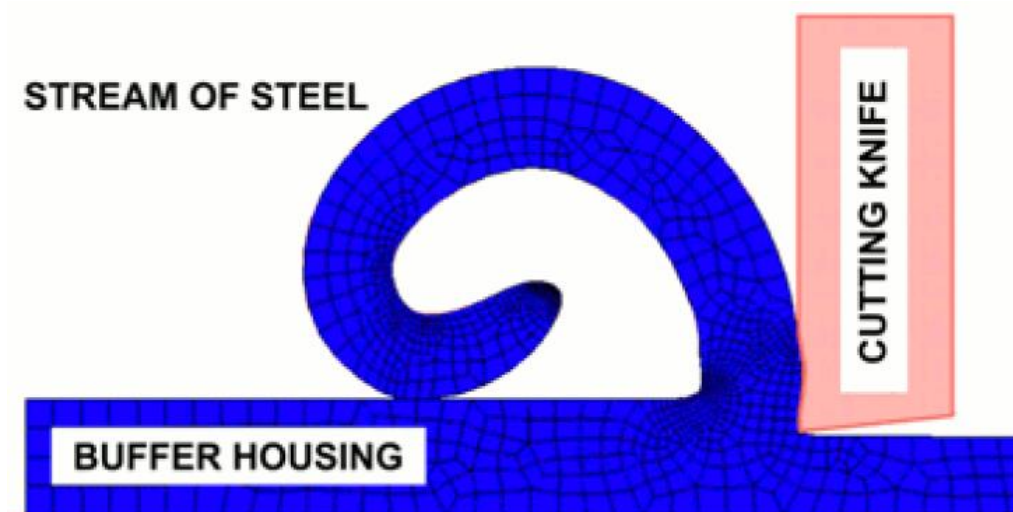
Obr. 5-10: Princip absorpce deformační energie pomocí třískového obrábění deformační trubky
