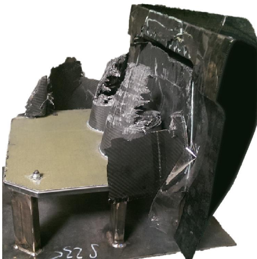
Obr. 52 – Deformační prvek po nárazové zkoušce
