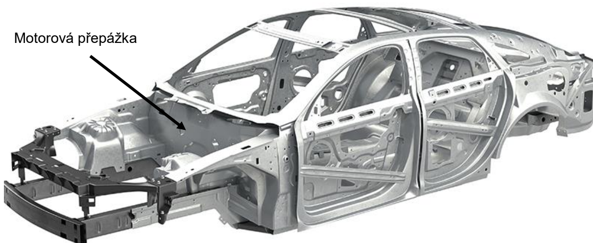
Obr. 5 – Struktura nosné karoserie [6]
