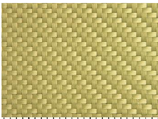
Obr. 13 – Kevlarová výztuž v keprové vazbě [12]
