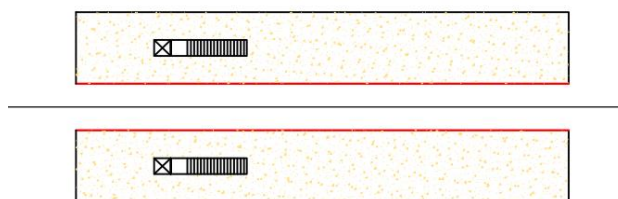
obr. 27: Špatný návrh nástupiště – dvě nástupní hrany pro jednu kolej
