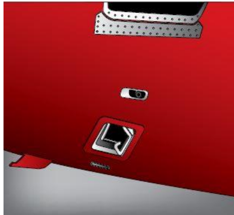
Obr. 10 Odtokový ventil dopravního letadla (převzato z literatury [3])
