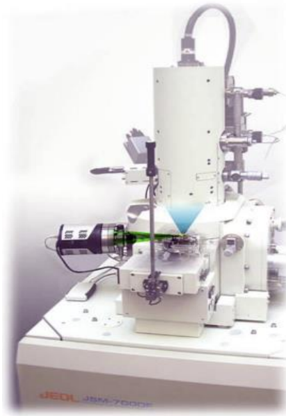
Obrázek 11 Počítačový tomograf připevněný na elektronový mikroskop [16]
