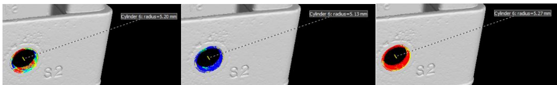
Obrázek 57 Měření průměru díry Gaussovou metodou
