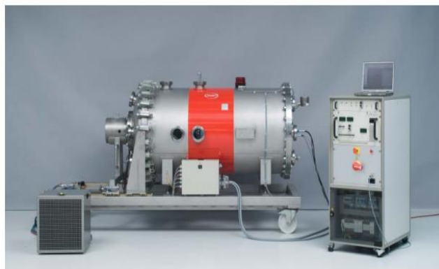
Obrázek 13 600 kV zdroj rentgenového záření [17] Obrázek 12 800 kV zdroj rentgenového záření [17]
