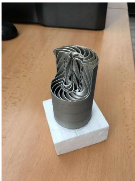
Obrázek 24 Ukázka upnutí tepelného výměníku vyrobeného technologií 3D tisku
