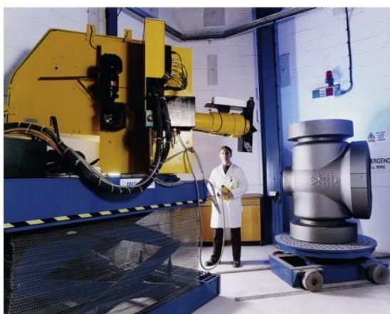
Obrázek 15 Prozařování 7000 kg ocelové součásti za pomoci lineárního akcelerátoru [16]
