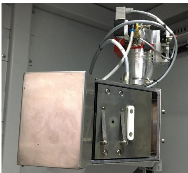
Obrázek 21 Zdroj rentgenového záření počítačového tomografu Metrotom 1500
