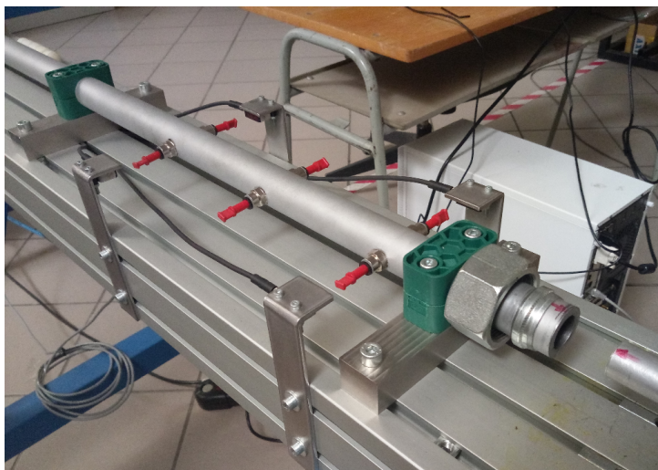
Obrázek 3.3: Původní řešení utěsnění otvorů pro odvětrání hlavně
