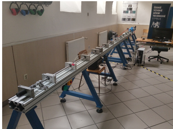
Obrázek 2.1: Schéma zařízení SHPB s popisem mechanických částí
