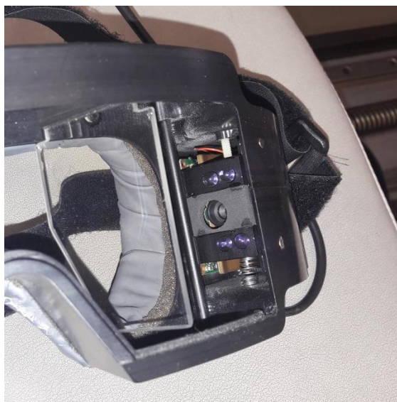
Obrázek 5 - detail na IR diody a analogovou IR kameru
