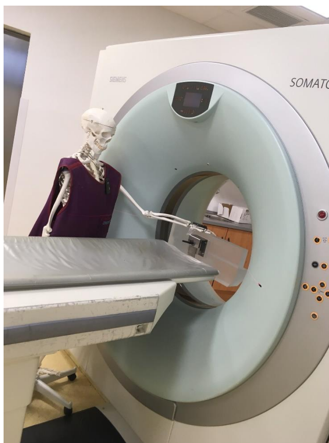
Obrázek 19 – Fantom s celotělovým fantomem (kostra člověka simulující personál) [Vlastní zdroj]
