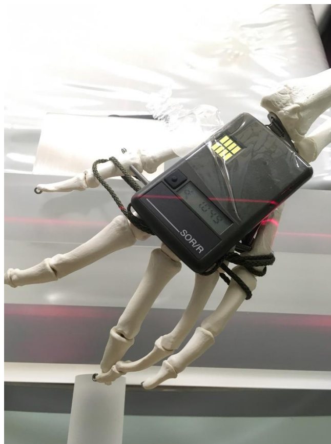
Obrázek 20 – Oblast ruky intervenujícího lékaře s přiloženým dozimetrem [Vlastní zdroj]
