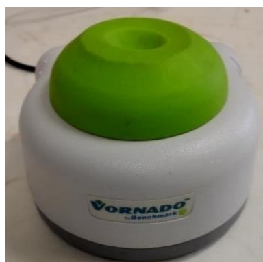
Obrázek 21: Homogenizátor typu vortex firmy Benchmark Scientific [autor]
