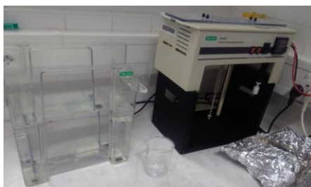
Obrázek 3.7: Elektroforetická vana na DGGE
