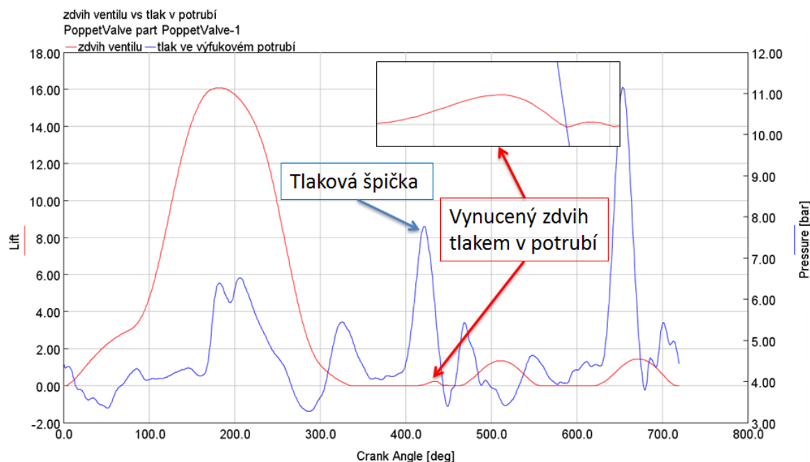
Obr 62. vliv tlaku ve výfukovém potrubí na zdvih ventilu
