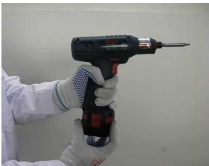
Obr. 22 - Zkouška tahem při výměně akumulátoru (autor: M. Koulová)
