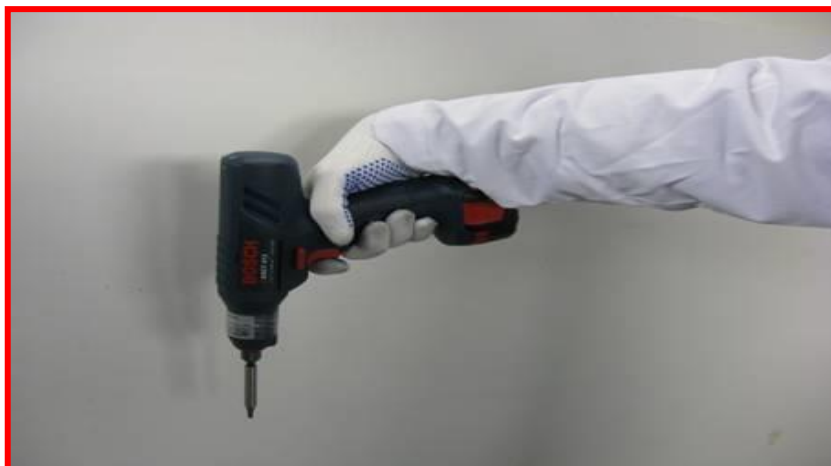
Obr. 27 - Nesprávné držení AKU zatahovačky, hrozí úraz v podobě vážného poranění šlach na zápěstí! (autor: M. Koulová)
