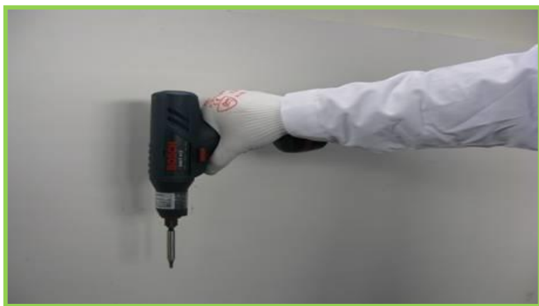
Obr. 28 - Správné ergonomické držení AKU zatahovačky (autor: M. Koulová)
