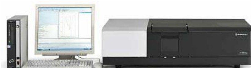
Obr. 6.2: Měřící pracoviště pro měření absorpčních spekter UV-VIS-NIR Shimadzu UV-3600 [20].
