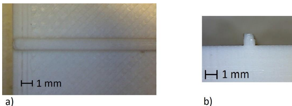
Obr. 7.1: Fotografie negativní předlohy přímého vlnovodu o rozměru drážky 1000\ \mu\text{m} z materiálu ABS-T a) pohled shora, b) pohled z čela.
