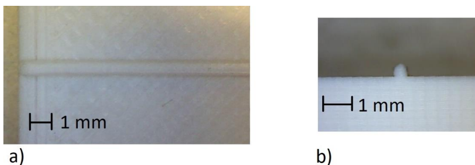
Obr. 7.2: Fotografie negativní předlohy přímého vlnovodu o rozměru drážky 550\ \mu\text{m} z materiálu ABS-T a) pohled shora, b) pohled z čela.
