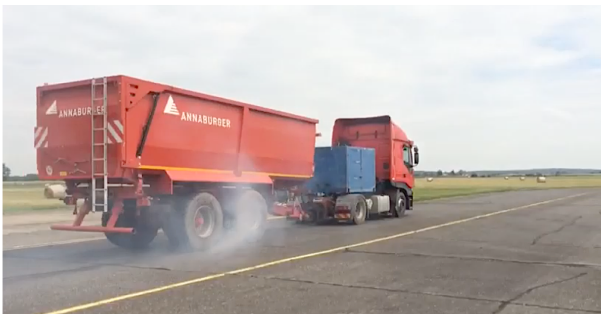
Fotografie 15 - Brždění bez ABS plným ovládacím tlakem v rychlosti 30 km/h (CZP30b)
