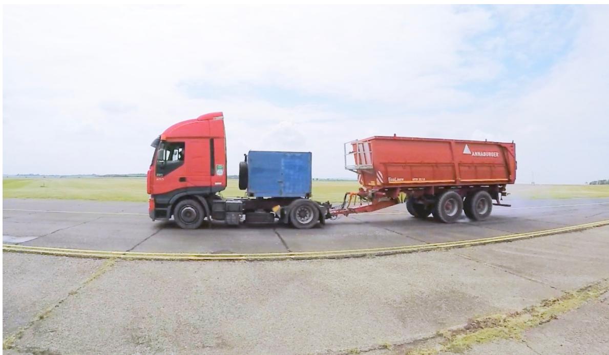
Fotografie 17 - Brždění s ABS plným ovládacím tlakem z rychlosti 60 km/h (CZP60)
