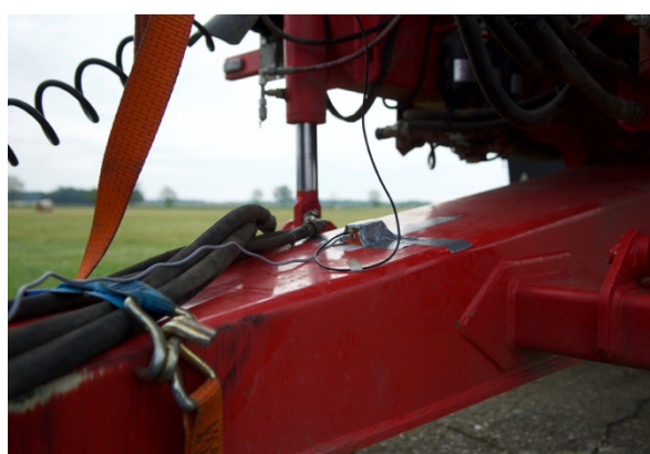
Fotografie 12 – Upevnění sdružených snímačů na oji návěsu
