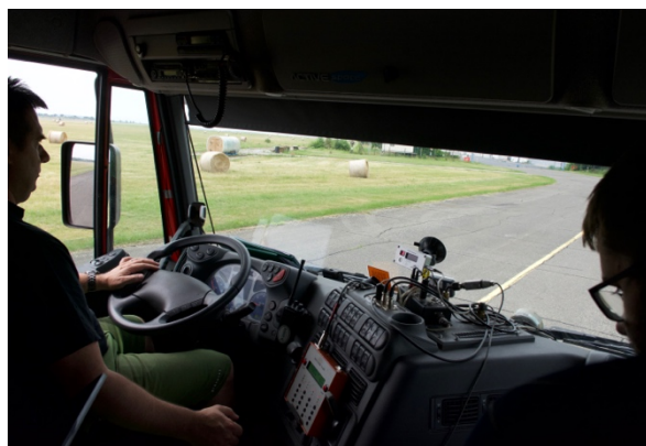
Fotografie 10 - Interiér měřicího tahače
