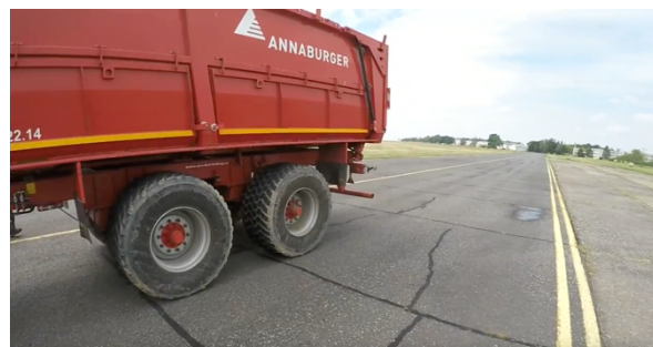
Fotografie 19 - Přerušovaná brzdná stopa po brždění s ABS z rychlosti 60 km/h
