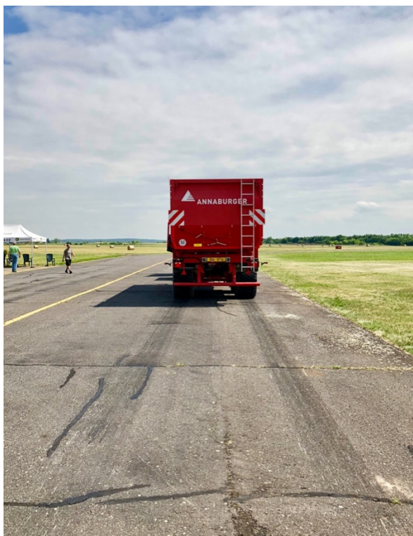
Fotografie 18 - Brzdní stopa po brždění bez ABS z rychlosti 40 km/h
