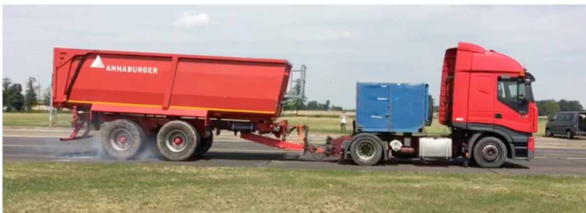
Fotografie 16 - Brždění bez ABS plným ovládacím tlakem v rychlosti 40 km/h (CZP40b)
