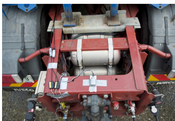
Fotografie 11 – Upevnění sdružených snímačů na tahači
