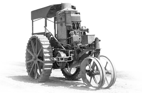
Obrázek 1 - Jednoválcový traktor Hart Parr z roku 1918 (asme.org, 2018)
