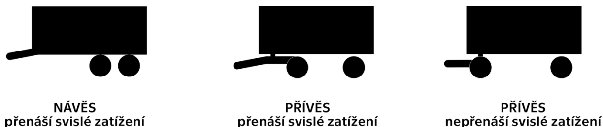
Obrázek 15 - Schéma rozdělení přípojných vozidel (Pinkas, 2018)
