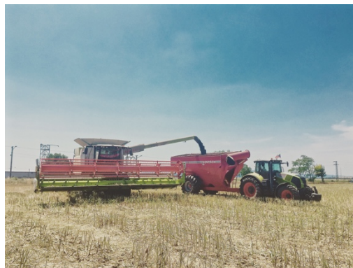
Obrázek 20 - Souprava traktoru T1a a jednonápravového přípojného vozidla R4a s technicky přípustnou hmotností na nápravu 28 500 kg
