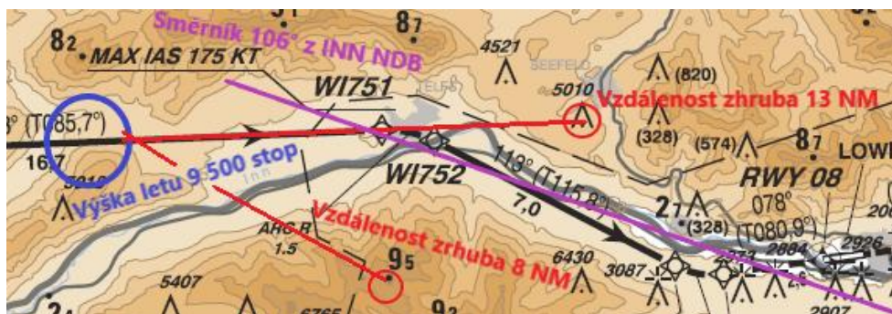
Obrázek 7: Naznačení nepředvídaného postupu RNAV(RNP) RWY 08 (výřez z (Austro Control, 2018))
