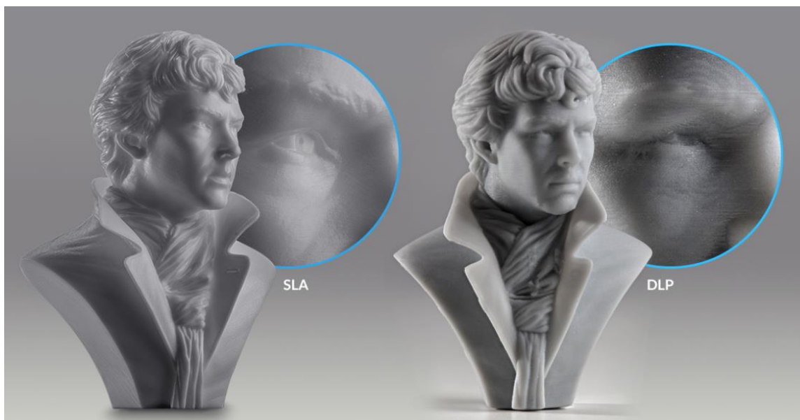
Obrázek č. 14 - Tisk objektu metodou SLA (vlevo) a metodou DLP (vpravo) [39]
