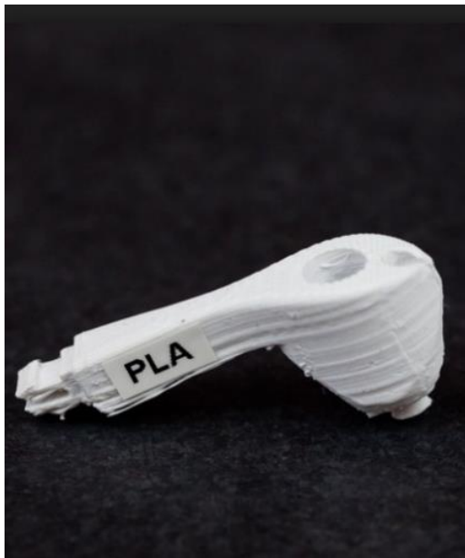
Obrázek č. 23 - Vytisknutý model z PLA materiálu [48]
