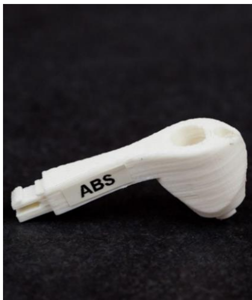
Obrázek č. 22 - Vytisknutý model z ABS materiálu [47]
