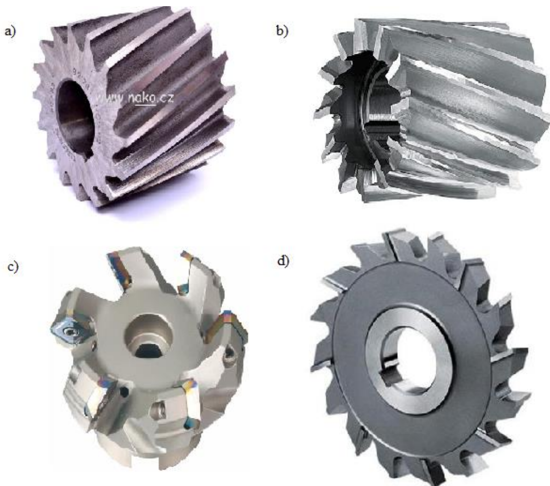
Obrázek 4: Typy fréz a) Válcová b) Válcová čelní c) Čelní d) Kotoučová [8, 9, 10, 11]
