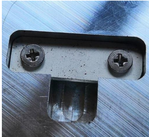
Obrázek 69: Dokončená kapsa pro zavěšení
