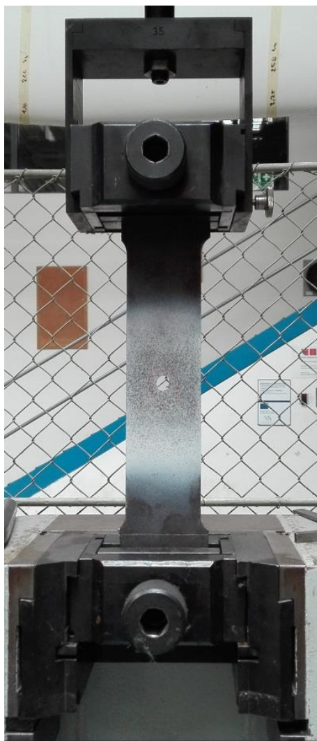
Obrázek 4.5: Uchycení vzorku do čelistí trhacího stroje
