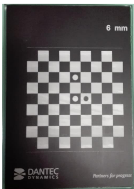
Obrázek 4.6: Kalibrační štítek pro kalibraci kamer
