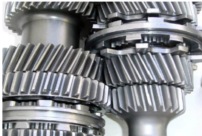
Obr. 18: Různé provedení čelních zubů. Vlevo – zuby přesuvníku zajíždí do drážek v kole, vpravo – zuby tvoří nalisovaný věnec na boku kola
